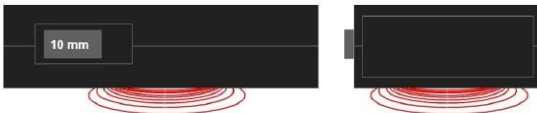
Widok z boku: Pole pomiarowe i głębokość penetracji dla ustawienia przełącznika „10 mm”
