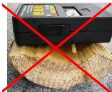
źle: pomarszczona powierzchnia (skrajny przypadek)
