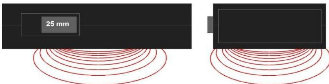
Widok z boku: Pole pomiarowe i głębokość penetracji dla ustawienia przełącznika „25 mm”
