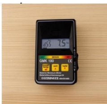
Fot 2. Prawidłowo: położone na powierzchni
