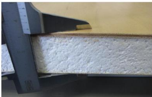
Przykładowa izolacja kanapkowa: aluminium - izolacja - sklejka
