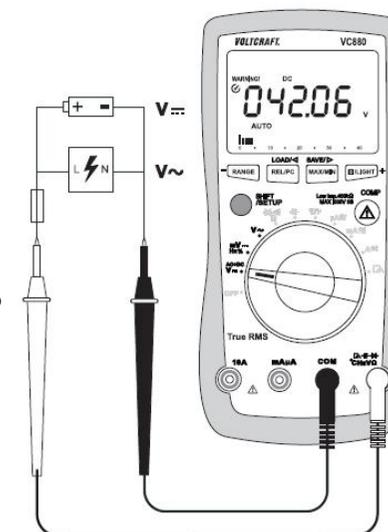
→ Jeśli z przodu zmierzonej wartości dla napięcia stałego pokaże się minus „-”, zmierzone napięcie jest ujemne (albo pręty pomiarowe są zamienione). Zakres napięcia „V DC/AC” pokazuje impedancję wejściową > 10 megaomów.
