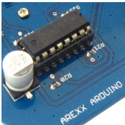
Rys. 12 Obwód z mostkiem H oraz chipem L293D.
