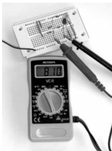
Rysunek 72: Drugą możliwość oferuje funkcja testowania diod miernika Voltcraft VC-11. Jeśli wskazana zostanie wartość pomiarowa, dioda mierzona jest w kierunku przepływu.
