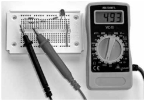
Rysunek 57: Na obu zamontowanych w naszym układzie w sposób równoległy względem siebie opornikach 1k\ \Omega można zmierzyć rezystencję całkowitą na poziomie 493\ \Omega .
