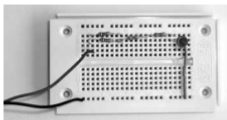
Rysunek 54: Układ mieszanego połączenia szeregowo-równoległego sterującego diodą LED.
