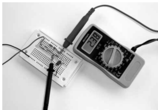
Rysunek 65: Przez oba oporniki 330 \Omega płynie po ok 2,4 mA.
