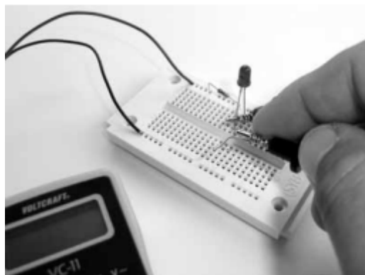
Rysunek 48: Miernik uniwersalny należy podłączyć do układu połączeń zamiast mostka drucianego. W ten sposób zostanie on połączony szeregowo z innymi elementami odbiorczymi.
