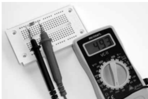
Rysunek 33: Dwa połączone równoległe oporniki 1 k Ω dadzą rezystencję całkowitą wynoszącą 493 Ω.
