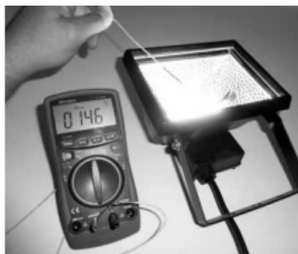
Rysunek 79: Czarny kabel należy połączyć z gniazdkiem COM na przyrządzie. Czerwony kabel podłączyć do gniazdka \Omega AmA°C .
