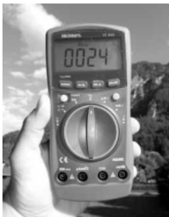
Rysunek 77: Jak tylko ustawiono na mierniku uniwersalnym zakres mierzenia temperatur, można zmierzyć temperaturę otoczenia.
