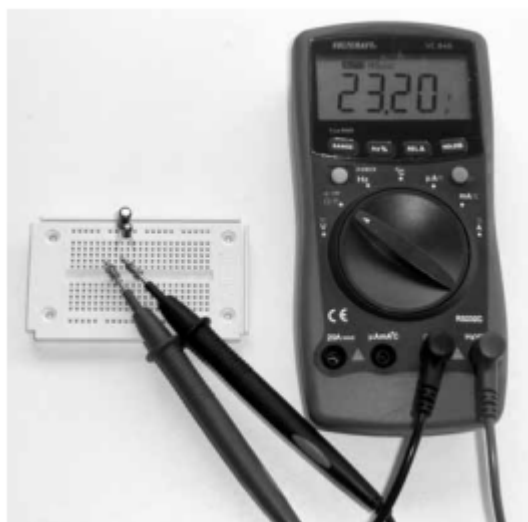
Rysunek 41: W przypadku dwóch równolegle połączonych kondensatorów 10 \mu F zmierzona zostanie suma pojedynczych pojemności obu kondensatorów.
