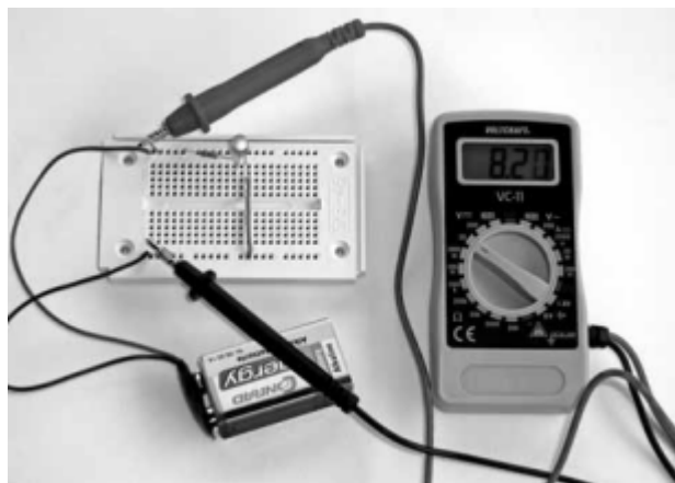
Rysunek 44: Jako napięcie całkowite wskazane zostanie 8,2 V.
