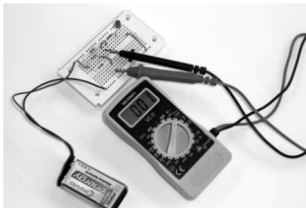
Rysunek 64: Przez bardzo wysoki opornik 2,2 M \Omega przepływa bardzo mało prądu. Zmierzona wartość na poziomie 1 mA może zostać wytłumaczona tylko dużym błędem pomiarowym. W rzeczywistości jest dużo niższa.
