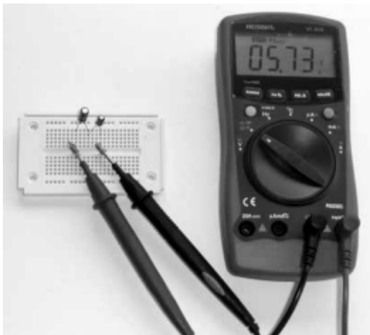
Rysunek 38: W przypadku podłączonych szeregowo kondensatorów 10\ \mu\text{F} zmierzona zostanie połowa pojedynczej pojemności danego kondensatora.
