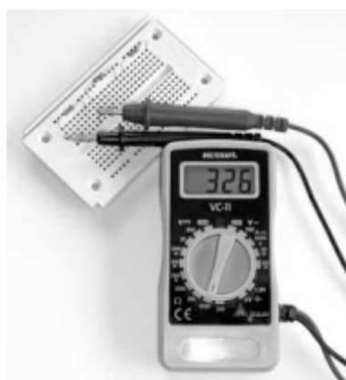
Rysunek 27: Przy prawidłowym ustawieniu wartości pomiarowej drugi, wcześniej zmierzony jako opornik 1 k Ω, okazuje się być opornikiem 330 Ω.
