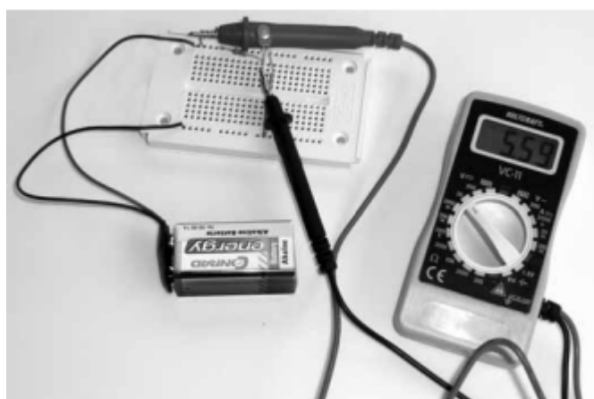
Rysunek 45: Na oporniku 1 k \Omega spada napięcie o wartości 5,59 V. Aby dokładnie zmierzyć napięcie należy zawsze ustawiać optymalny zakres pomiarowy.
