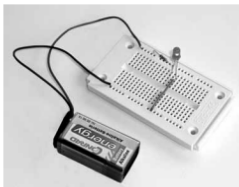
Rysunek 43: Schemat prostego połączenia LED
