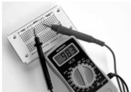
Rysunek 26: W zakresie pomiarowym 2.000 Ω zmierzona zostaje wartość rezystencji wynosząca 983 Ω. Tym samym dla tego opornika znaleziony został optymalny zakres pomiarowy.
