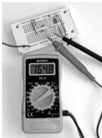
Rysunek 71: Jeśli przytrzymamy czerwony kabel do oznaczonej przez pierścień strony diody, zmierzona zostanie ona w kierunku przepływu.
