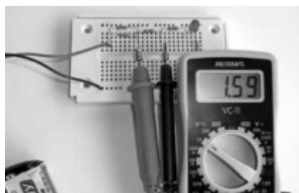
Rysunek 56: Na dwóch jednakowej wielkości podłączonych szeregowo opornikach również zmierzyć można taki sam spadek napięcia.
