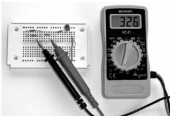
Rysunek 59: Pomiar pojedynczych oporników w układzie jest tylko wtedy prawidłowy, jeśli nie są do nich podłączone równoległe żadne inne elementy.
