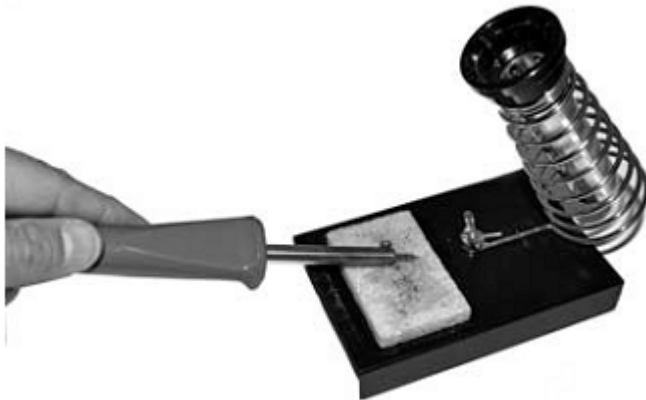
Ryc. 25: Dlatego często wycieraj zanieczyszczenia za pomocą wilgotnej gąbki.
