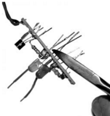
Ryc. 61: Po zakończeniu budowy i sprawdzeniu obwodu należy skrócić zbyt długie przewody połączeniowe.
