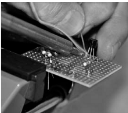
Ryc. 55: Połączenie tranzystora należy przylutować w ciągu kilku sekund.
