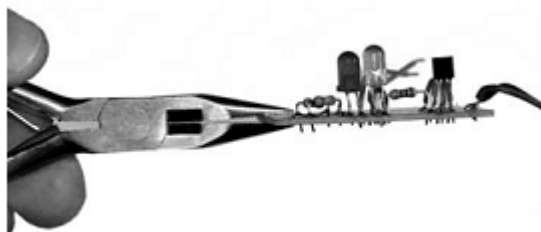
Ryc. 62: Obcięte połączenia powinny wystawać nad płytkę drukowaną o 0,5 – 1 mm.
