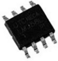
Ryc. 16: W układzie scalonym SMD wtyk 1 jest oznaczony punktem na górze obudowy.
