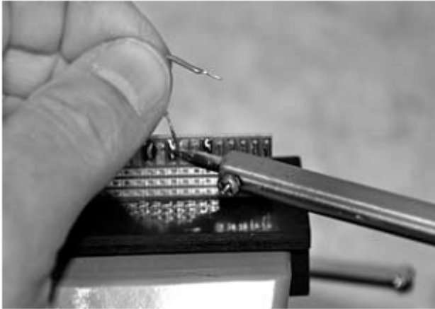
Ryc. 35: Delikatnie ciągnij za przewód palcami podczas nagrzewania powierzchni lutowania aż do odłączenia przewodu.
