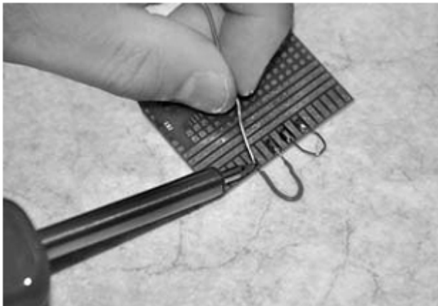
Ryc. 31: Lutowanie mostków przewodów na bocznych ścieżkach przewodzących
