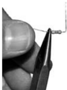
Ryc. 30: W przypadku elementów elektrycznych przewodów nie należy zaginać bezpośrednio przy krawędzi obudowy.
