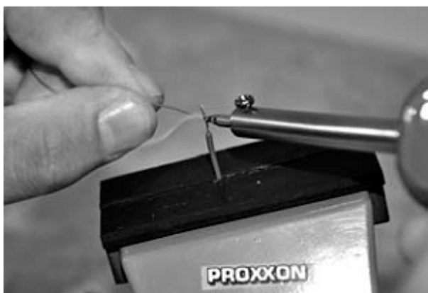
Ryc. 27: Skręcony przewód należy podgrzać i dodać do niego lutu, który od razu się stopi.
