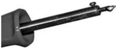
Ryc. 24: Z czasem na grocie lutowniczym gromadzi się lut, który znacznie utrudnia lutowanie.
