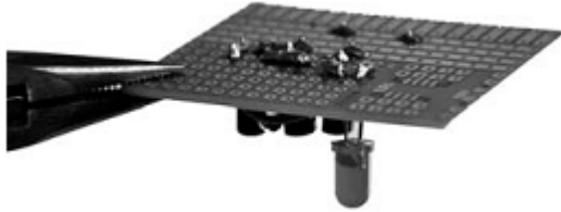
Ryc. 63: Odetnij przewody połączeniowe tuż przy stożkach lutowniczych.
