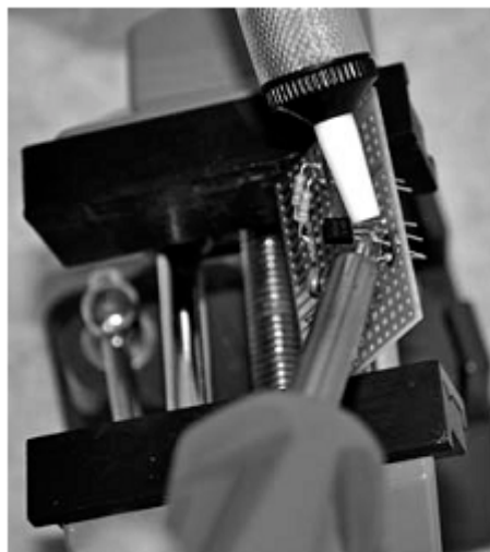
Ryc. 57: Grudki lutu można usunąć, nagrzewając je i stosując pompę rozlutowującą.
