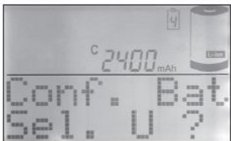
Rys. 14: Wprowadzanie znamionowego napięcia akumulatora
