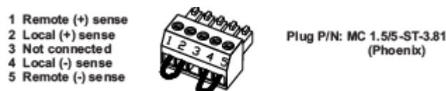
Rys. 3-5: Złącze wykrywania, domyślne podłączenie
