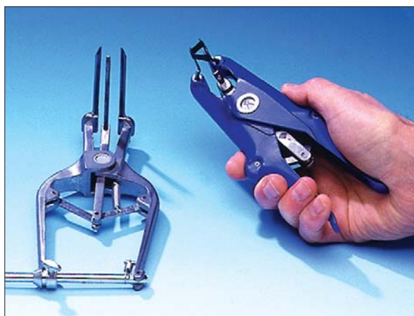
Szybki i wygodny montaż przy pomocy rozwieraków trójzębnych.
