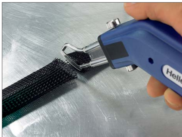
Cięcie przy pomocy HSG0 zapobiega rozplataniu się opłotów.
