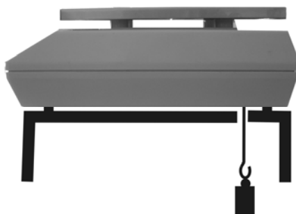
Rys. 1: Ustawienie wagi do ważenia pod podłogą
