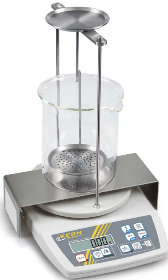
Rys. 1: Waga KERN EMB 2000-2V z zainstalowanym zestawem do oznaczania gęstości KERN YDB-02
