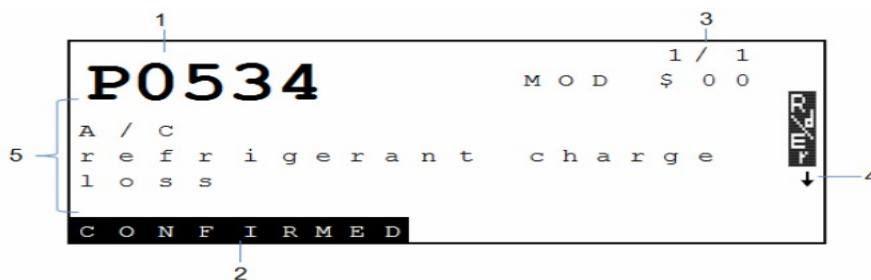
Rys. 4: Wyświetlanie kodu usterki - opis z góry lewego i dolnego rogu
