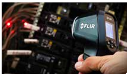
Łatwa identyfikacja punktu pomiarowego za pomocą wbudowanego wskaźnika laserowego
