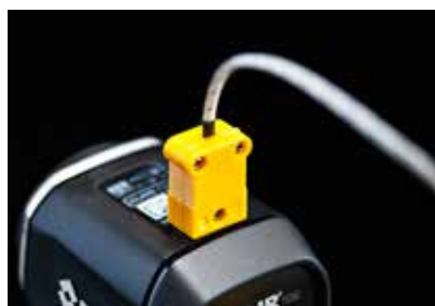
TG56 jest wyposażony w wejście dla termopary typu K
