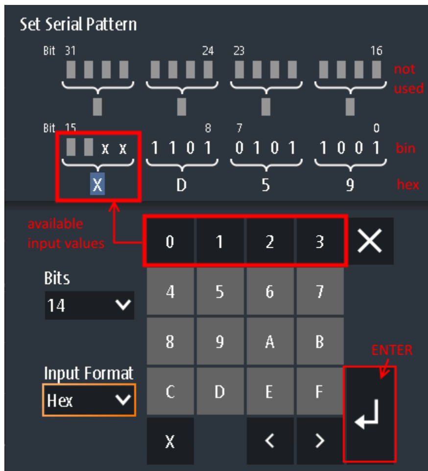
Rysunek 3-17: Edytor wzorców dla 14-bitowego wzorca w formacie szesnastkowym
