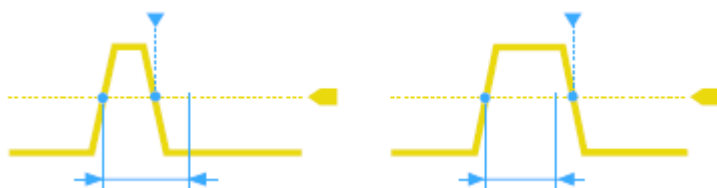
Rys. 3-5: Szerokość impulsu jest krótsza lub dłuższa niż zadana szerokość (tak samo jak w wyzwalaniu usterki)
