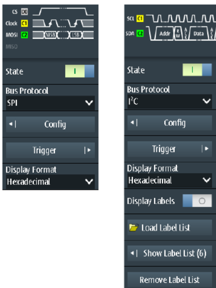
Rysunek 9-1: Menu Bus. Po lewej: dla protokołów bez adresu (SPI, UART). Po prawej: dla protokołów z adresem lub identyfikatorem (I 2 C, CAN, LIN, SENT)
