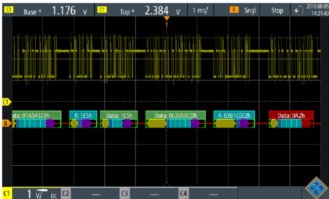
Rysunek 9-30: Wyświetlanie grzebienia dekodowanego sygnału CAN, wyzwanego adresem 0630ABCD (hex)
