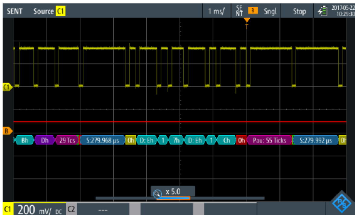
Rysunek 9-44: Wyświetlanie kombinacji zdekodowanego sygnału SENT, wywołanego przez szybkie CRC
