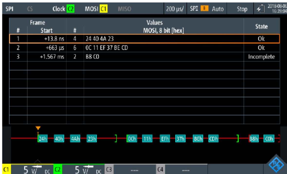
Rysunek 9-18: Zdekodowany sygnał SPI w trybie protokołu
