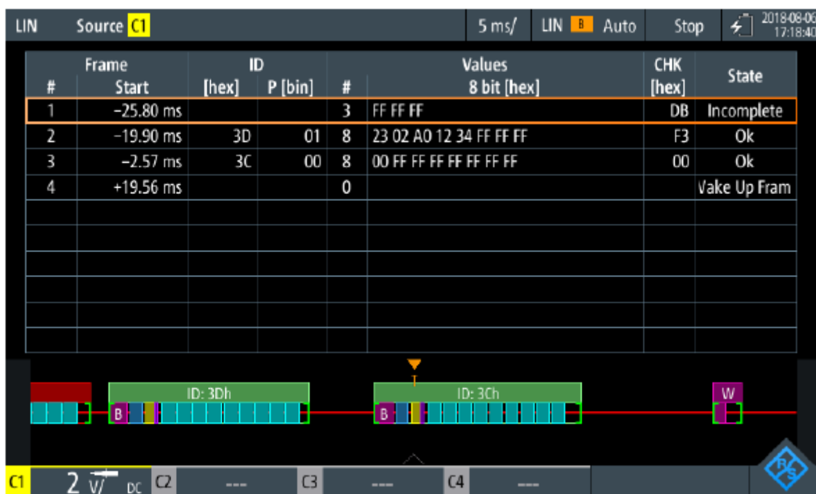
Rysunek 9-38: Zdekodowany sygnał LIN w trybie protokołu
