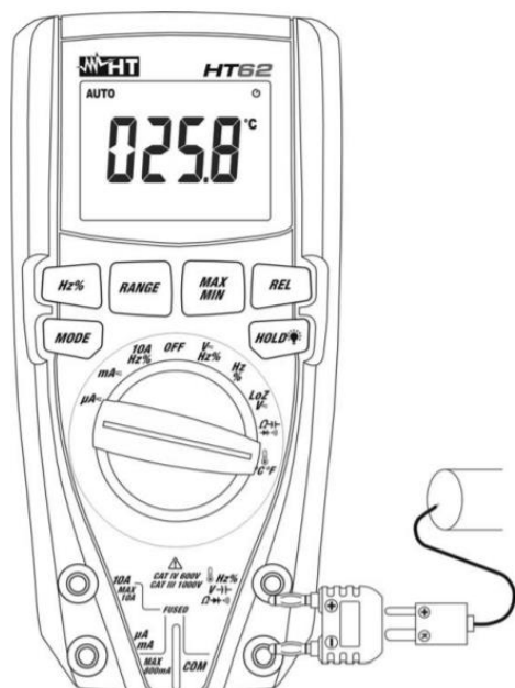
Rys. 9: Użycie przyrządu do pomiaru temperatury
