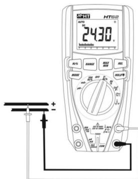
Rys. 2: Użycie przyrządu do pomiaru napięcia DC
