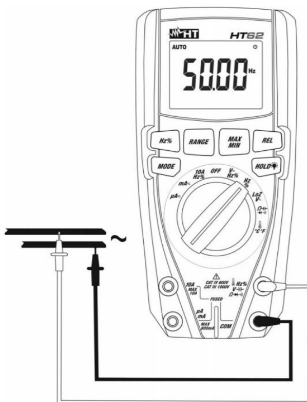
Rys. 5: Wykorzystanie przyrządu do pomiaru częstotliwości i testu współczynnika wypełnienia
