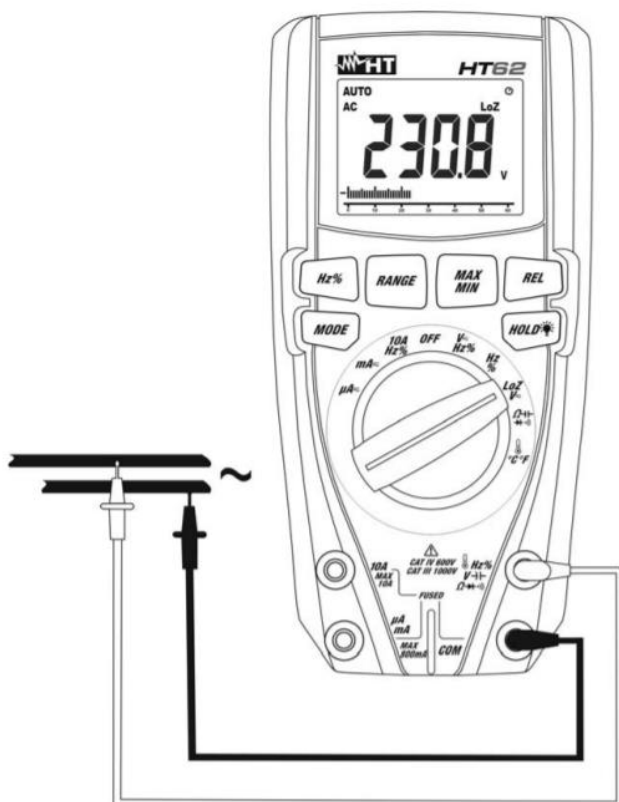
Rys. 4: Zastosowanie przyrządu do pomiaru napięcia AC/DC o niskiej impedancji (LoZ)
