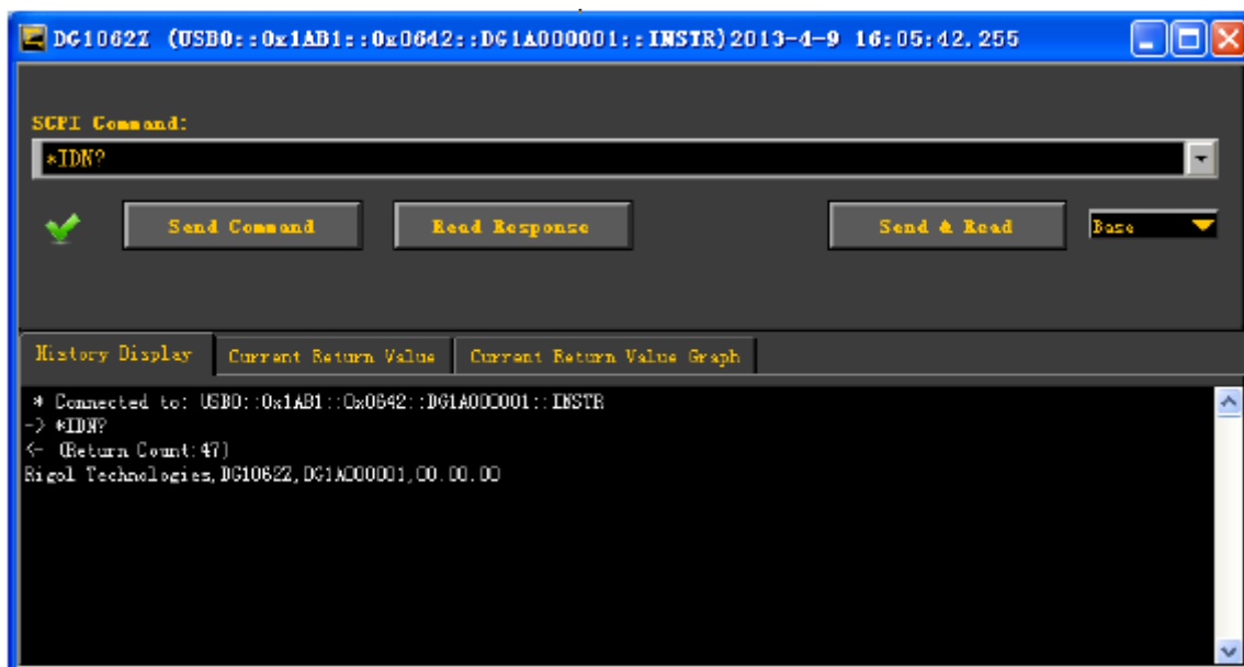
Rys. 12 Wysyłanie i odczytywanie poleceń przez USB
