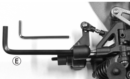
Dokręcanie/luzowanie wkrętu bez łba (C)
