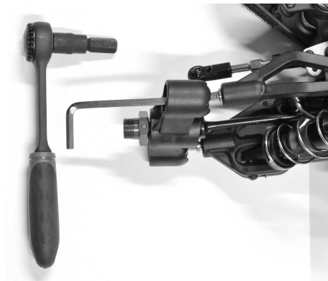
Regulowanie śrub kulowych (A i B)
