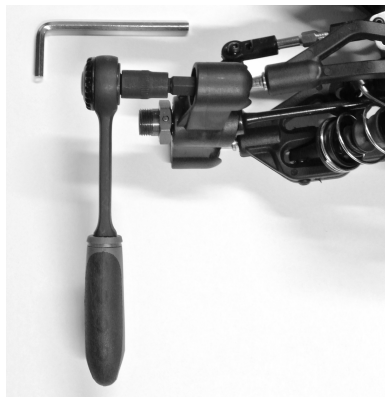
Dokręcanie/luzowanie wkrętów bez łoża (C)
