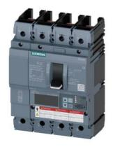
Leistungsschalter 3VA6 UL Frame 150 Schaltvermögenklasse H 65kA @ 480V 4-polig, Anlagenschutz ETU820, LI, In=150A Überlastschutz, 100% rated Ir=60A...150A Kurzschlussschutz Ii=1,5...10 x In ohne Anschluss
