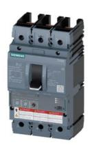
Leistungsschalter 3VA6 UL Frame 150 Schaltvermögenklasse C 100kA @ 480V 3-polig, Anlagenschutz ETU320, LI, In=150A Überlastschutz, 100% rated Ir=60A...150A Kurzschlussschutz Ii=1,5...10 x In ohne Anschluss
