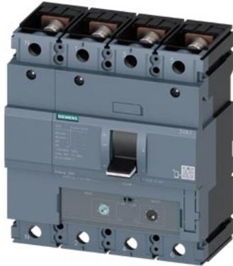
Leistungsschalter 3VA1 IEC Frame 250 Schaltvermögenklasse S Icu=36kA @ 415V 4-polig, Anlagenschutz TM240, ATAM, In=250A Überlastschutz Ir=175A...250A Kurzschlusschutz Ii=5...10 x In N-Leiter ungeschützt Schraubenflachanschluss
