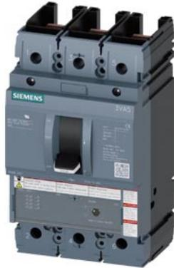
Leistungsschalter 3VA5 UL Frame 250 3-polig, Starterschutz TM120M, AM, In=150A ohne Überlastschutz Kurzschlusschutz Ii=3...6 x In ohne Anschluss
