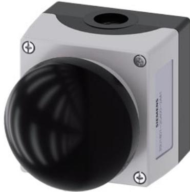
Gehäuse für Befehlsgeräte, 22 mm, rund, Gehäusematerial Kunststoff, Gehäuseoberteil grau, 1 Befehlsstelle Kunststoff, Befehlsstelle mittig, A=Grobhandtaster schwarz, tastend, 1S, Schraubanschluss, Bodenbefestigung
