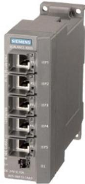
SCALANCE X005, IE Entry Level Switch unmanaged 5x 10/100 Mbit/s RJ45 Ports, LED-Diagnose, IP30, DC 24V Spannungsversorgung, PROFINET-konforme Haltekragen, erweiterter Temperaturbereich -40°C...+75°C, Handbuch als Download verfügbar .
