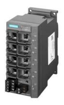
SCALANCE X108PoE unmanaged IE Switch, 2x 10/100 Mbit/s RJ45 Power- over-Ethernet Ports und 6x 10/100 Mbit/s RJ45 Ports, LED-Diagnose, Fehlermelde- Kontakt mit Set-Taster, redundante Spannungsversorgung Handbuch als Download verfügbar .
