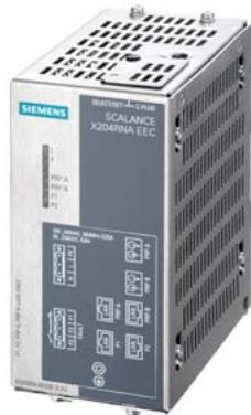
SCALANCE X204RNA EEC; Redundant Network Access 2x 100 Mbit/s RJ45 Ports; 2x 100 Mbit/s Combo-Ports; LED-Diagnose; Fehlermelde-Kontakt mit Set-Taster; einfache Spannungsversorgung; Netzwerk-Management; inkl. elektron. Handbuch auf CD-ROM, C-PLUG optional für HSR Netzwerk;
