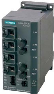
SCALANCE X204-2, managed IE Switch, 4x 10/100 Mbit/s RJ45 Ports, 2x 100 Mbit/s Multimode BFOC, LED-Diagnose, Fehlermeldekontakt mit Set-Taster, redundante Spannungsversorgung, PROFINET IO Device, Netzwerk-Management; Redundanz-Manager integriert, inkl. elektron. Handbuch auf CD-ROM, C-PLUG optional.
