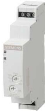
Zeitrelais, elektronisch ansprechverzögert 1 Wechsler, 7 Zeitbereiche 0,05 s...100 h AC/DC 110 V, 0,7...1,15 x US Schraubanschluss
