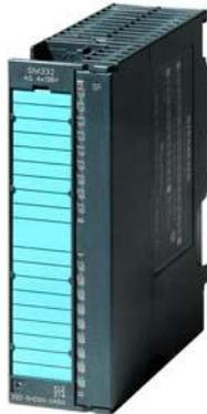
SIMATIC S7-300, Analogausgabe SM 332, potentialgetrennt, 4 AA, U/I; Diagnose; Auflösung 11/12 Bit, 20-polig, Ziehen und stecken mit aktivem Rückwandbus möglich
