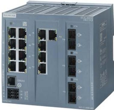
SCALANCE XB213-3 managebarer Layer 2 IE Switch 13x 10/100 Mbit/s RJ45 Ports, 3x MM FO SC-Port 1x Konsolen-Port, Diagnose-LED, redundante Spannungsversorgung, IEC 62443-4-2 zertifiziert; Temp.-Bereich 0°C bis +60°C; Hutschienenmontage; Default PROFINET.
