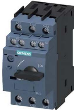
Leistungsschalter Baugröße S00 für den Motorschutz, CLASS 10 A-Auslöser 5,5...8 A N-Auslöser 104 A Schraubanschluss Standardschaltvermögen mit querliegenden Hilfsschalter 1S+1Ö
