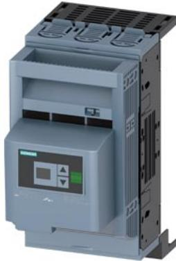
SENTRON, Sicherungslasttrennschalter 3NP1, 3-polig, NH00, 160 A, für Sammelschienensystem Rittal 40mm, Flachanschluss, Sicherungsüberwachung: elektronisch EFM20, Abdeckebene 32/70mm
