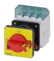
SENTRON, Lasttrennschalter 3LD, Not-Aus-Schalter, 4- polig, lu: 16 A, Betriebsleistung / bei AC-23 A bei 400V: 7,5 kW, Frontbefestigt, Knebelantrieb, rot/gelb, Zentralbefestigung 22,5mm der Handhabe
