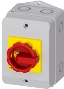
SENTRON, Lasttrennschalter 3LD, Not-Aus-Schalter, 3- polig, Iu: 16 A, Betriebsleistung / bei AC-23 A bei 400V: 7,5 kW, Isolierstoff- Kapselung für metrische Verschraubung, Drehantrieb, rot/gelb
