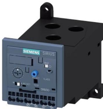
Überlastrelais 20...80 A elektronisch für Motorschutz Baugröße S2, CLASS 10E Einzelaufstellung Hauptstromkreis: Durchsteckw. Hilfsstromkreis: Federzugklemme Hand-Automatik-RESET
