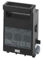
SENTRON, Sicherungslasttrennschalter 3NP5, 3-polig, NH00, 160 A, mit Adapter für Sammelschienensystem 8US 40mm, mit Schnelleinschaltung, Klemmbügel, Hilfsschalter am Lasttrennschalter: 1S+1Ö
