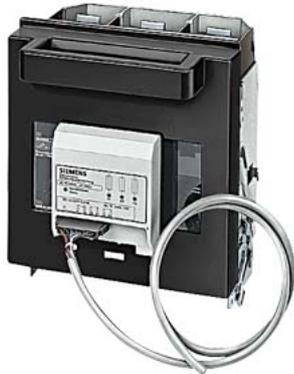
SENTRON, Sicherungslasttrennschalter 3NP5, 3-polig, NH2, 400 A, für Aufbau und Einbau auf Montageplatte, mit Schnelleinschaltung, Schraubanschluss, Sicherungsüberwachung: elektronisch, Hilfsschalter am Lasttrennschalter: 1S+1Ö, Hilfsschalter an der Sicherungsüberwachung: 2S+1Ö
