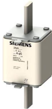
NH-Sicherungseinsatz, NH2, In: 300 A, gG, Un AC: 500 V, Un DC: 440 V, Stirnkennmelder, spannungsführende Griffflaschen
