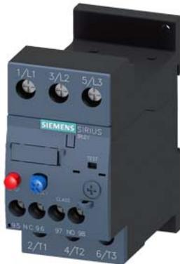
Überlastrelais 20...25 A thermisch für Motorschutz Baugröße S0, CLASS 10 Einzelaufstellung Hauptstromkreis: Schraub Hilfsstromkreis: Schraub Hand-Automatik-RESET
