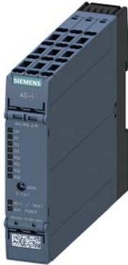
AS-i SlimLine Compact Modul SC22.5 digital, A/B-Slave 4DI/4RQ, IP20 4 x Eingang für 3-Leiter Sensor Sensorversorgung umschaltbar 4 x Ausgang Relais 1 A DC 24 V Federzugklemmen Baubreite 22,5 mm
