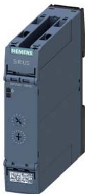
Zeitrelais, elektronisch rückfallverzögert ohne Steuersignal oder ablaufsicher einschaltwischend nullspannungssicher 7 Zeitbereiche 0,05...600 s AC/DC 12-240 V, 2 Wechsler bei AC 50/60 Hz mit LED, Schraubanschluss
