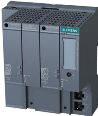
XF201-3P IRT managed IE IRT Switch, 1x 10/100Mbit/s RJ45-Ports, 3x 100Mbit/s POF SC RJ Ports, Busadapter mont., Fehlermeldekontakt mit Set- Taster, redundante Spannungs- Versorgung, PROFINET IO Device, Netzwerk-Management, Redundanz-Manager integriert, inkl. elektron. Handbuch auf CD-ROM, C-PLUG optional.
