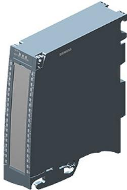
SIMATIC S7-1500, TM PTO 4 Schnittstellenbaugruppe für Schrittantriebe 4 Kanäle Pulse Train Output PTO: 24 V, RS-422, 5V, 2 DI, 1 DQ 24VDC pro Kanal
