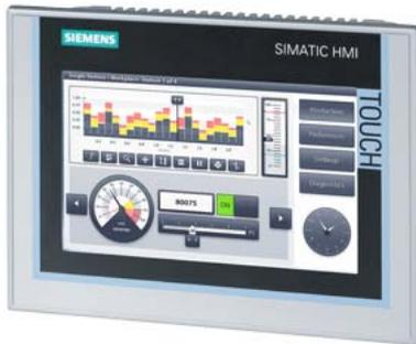
SIMATIC HMI TP700 Comfort, Comfort Panel, Touchbedienung, 7" Widescreen-TFT-Display, 16 Mio Farben, PROFINET Schnittstelle, MPI/PROFIBUS-DP Schnittstelle, 12MByte Projektierungsspeicher, Windows CE 6.0, projektiert ab WinCC Comfort V11
