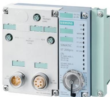
SIMATIC DP, CPU 1516PRO-2 PN für ET 200pro, Zentralbaugruppe mit Arbeitsspeicher 1MByte für Programm und 5MByte für Daten, 1. Schnittstelle: PROFINET IRT mit 3-Port-Switch, 2. Schnittstelle: PROFINET RT, 10 ns Bit-Performance, Schutzart: IP65/67, SIMATIC Memory Card notwendig, Anschlussmodul notwendig
