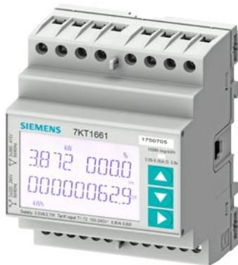
SETRON, Messgerät, 7KT PAC1600, LCD, L-L: 400 V, L-N: 230 V, 5 A, Hutschiengerät, 3-phasig, Modbus RTU/ASCII + MID, Schein- / Wirk- / Blindenergie, eigenversorgt, Schraubanschluss
