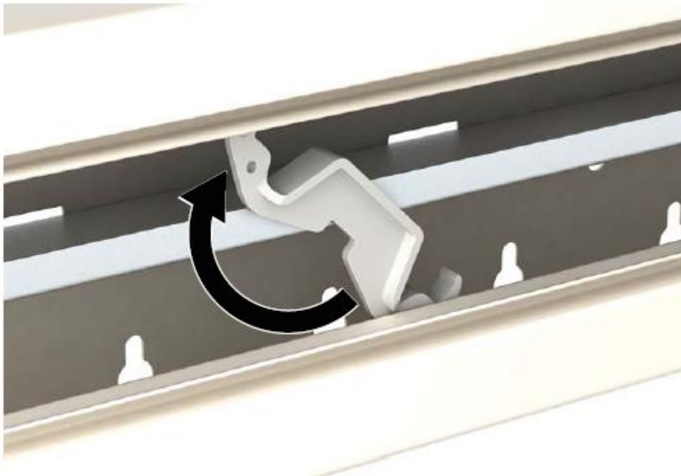
Rysunek 23 Zakładanie obejmę górnej części w systemach kanałów GS, GA i ISS
