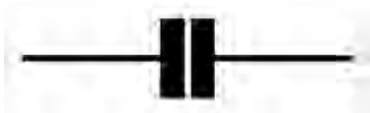
Rys. 5: Symbol obwodu kondensatora ceramicznego
