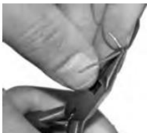
Rys. 28: Drut jest wyginany za pomocą okrągłych szczypecie dla elektroniki.
