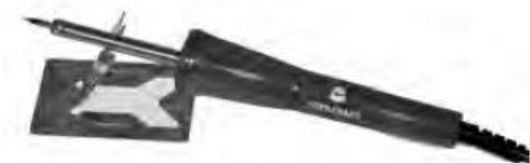
Rys. 17: drobna lutownica 15 W firmy Conrad Electronic (nr zam.: 588539); to najlepszy sposób na lutowanie elektroniczne.
