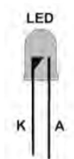
Rys. 9: Dioda LED musi być zawsze instalowana z właściwą polaryzacją.
