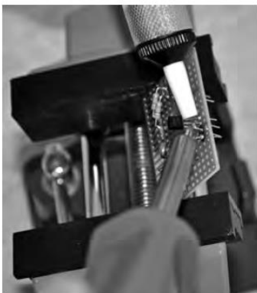
Rys. 57: Kawałki lutowia można usunąć przez podgrzanie i odkurzenie pompą rozlutowującą.
