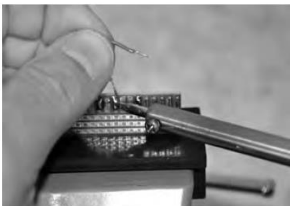
Rys. 35: Podczas nagrzewania się powierzchni lutowniczej delikatnie pociągnij drut palcami, aż się poluzuje.
