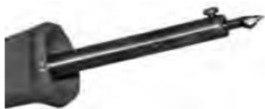
Rys. 23: Z biegiem czasu lut zbiera się na grocie lutowniczym, co znacznie utrudnia dalsze lutowanie.
