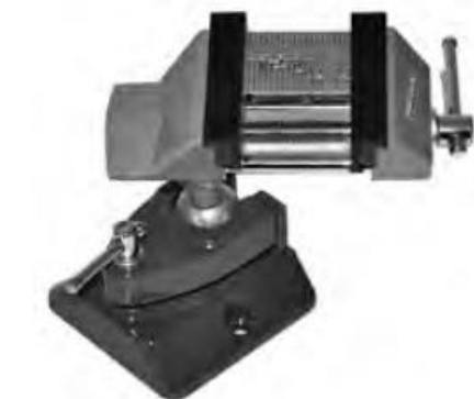
Rys. 19: Płytki drukowane można dobrze zamocować w imadle mechaniki precyzyjnej i wygodnie lutować.
