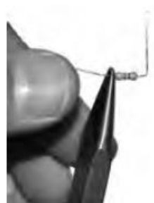
Rys. 29: W przypadku elementów elektrycznych nie należy zaginać przewodów bezpośrednio na końcu obudowy.
