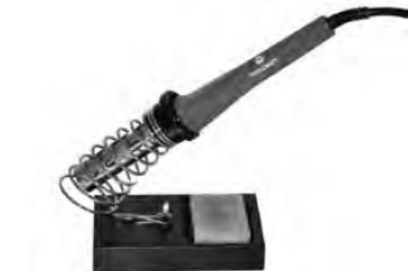
Rys. 18: Stabilny stojak na lutownicę z gąbką lutowniczą do czyszczenia zabrudzonych grotów lutowniczych
