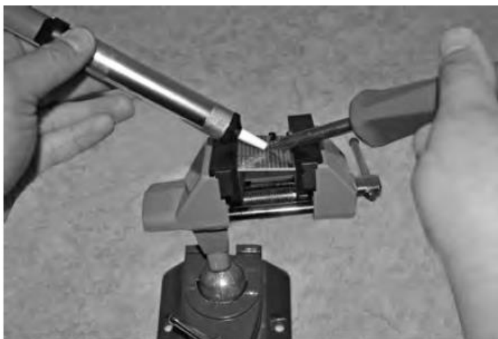
Rys. 65: Rozlutownica działa tylko za pomocą pompy ssącej rozlutownicy.
