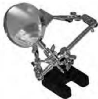
Rys. 20: Pomoce lutownicze z lupą również utrzymują płytkę w miejscu.
