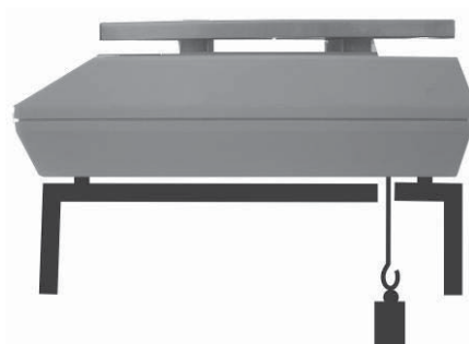
Rys. 1: Ustawienie wagi do ważenia pod podłogą
